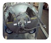
II sistema di ricoper tura DRUM COATER VALVE è una mae china completa, in grado di ricoprire in modalità batch.
