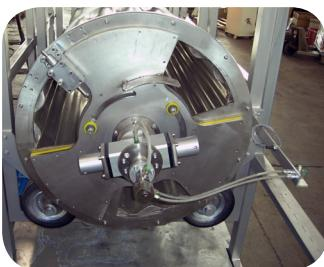
Il sistema di ricopertura DRUM COATER VALVE è una macchina completa, in grado di ricoprire in modalità batch. Il tamburo è corredato di un sistema a valvola sulla bocca di scarico, in modo tale da rimescolare il prodotto più volte. Questo permette una ottima omogeneicità di copertura su tutta la superficie del prodotto, anche ad elevate percentuali di additivo.
