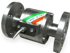
**CPO** : Contalitri volumetrico a disco nutante, idoneo per il dosaggio di liquidi alimentari. Buona affidabilità, semplice design. 1% di precisione sul prodotto dosato. Corpo in AISI, pistone in Teflon .Lancia impulsi REED. Su richiesta attacchi flangiati e camera di preriscaldo.
